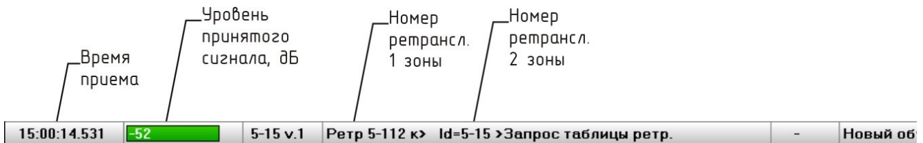
Рисунок 22 - Пример пакета «Запрос таблицы ретрансляторов»
